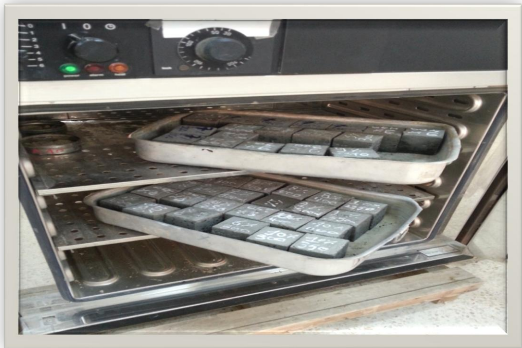
Figure II.8 : Les éprouvettes dans l'étuve.
