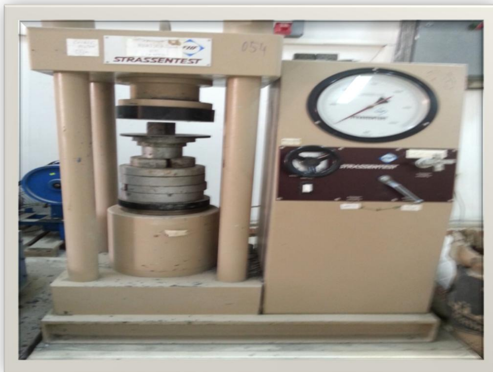
Figure II.6: La machine d'essai de résistance à la compression.
