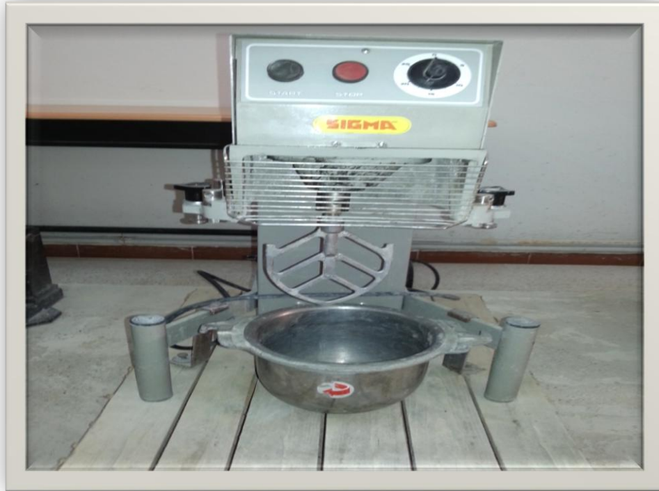
Figure II.5: Un malaxeur SIGMA.
