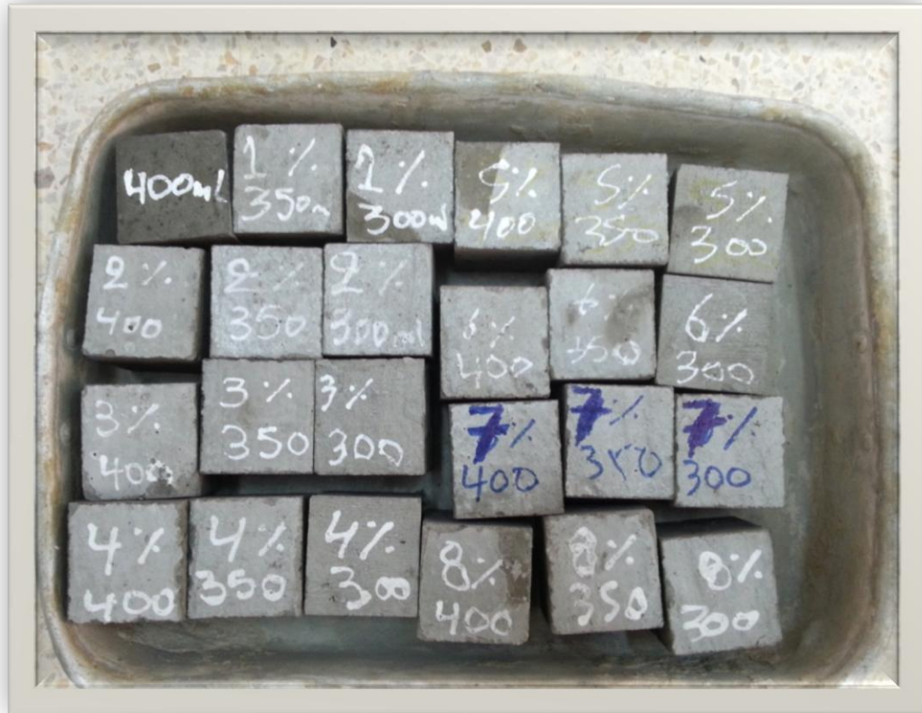
Figure II.9 : Les éprouvettes dans l'air libre.
